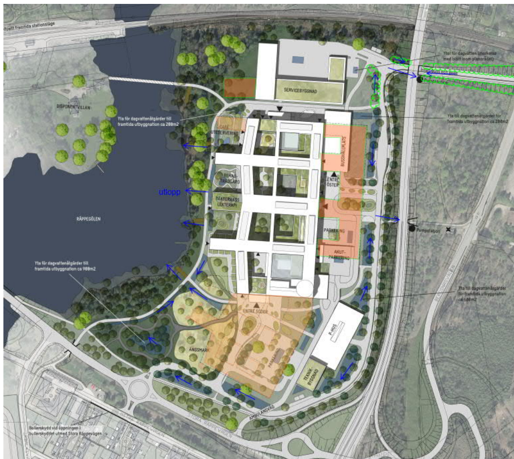
Figur 20 Förslag till hantering av dagvatten inom kvartersmark. Eventuella framtida utbyggnader visas transparenta i orange. Gröna markeringar visar föreslagna dagvattenhantering vid infart från Bergsnäsvägen. Riktningsspilar i blå visar flödesvägar. (Sweco, 2021f)
