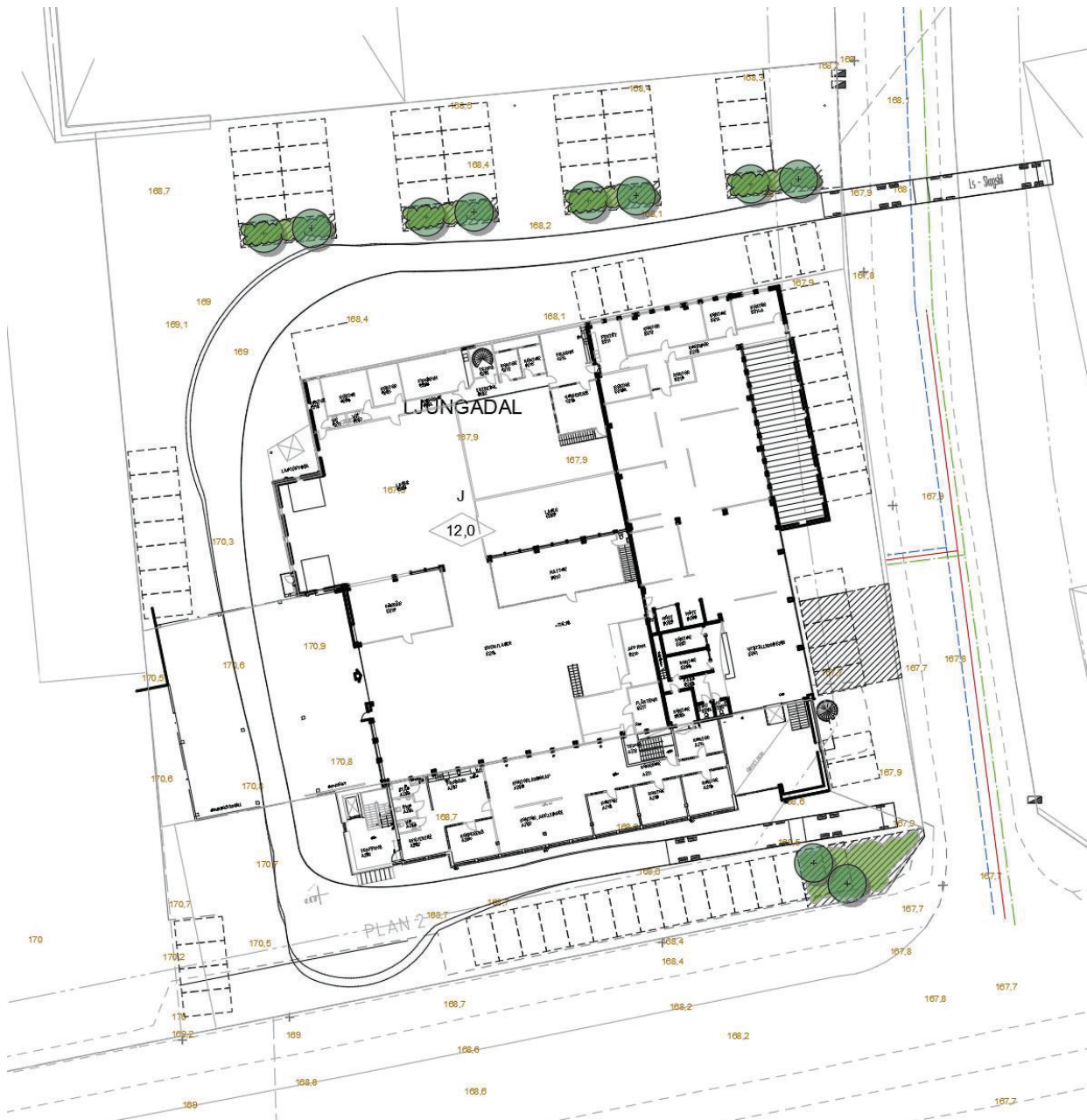
Bild 4.4 Skiss visande möjlig utformning vid översyn av utemiljön med lägen för ytliga regnbäddar i norr och söder samt för ett underjordiskt magasin utmed Slöjdgatan. Körspår för stor lastbil med släp är inlagt för att säkerställa att utrymme finns tillgängligt.
