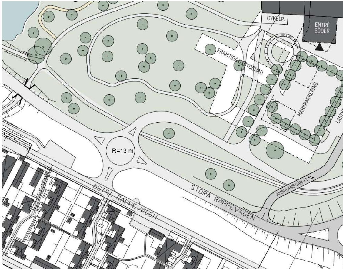
Figur 27 Förslagsskiss på ny cirkulationsplats med radie 13 m vid angringspunkt till nya sjukhusområdet. Utsnitt från illustrationsplan för nya sjukhusområdet, dat. 2021-02-24 (Sweco, 2021)
